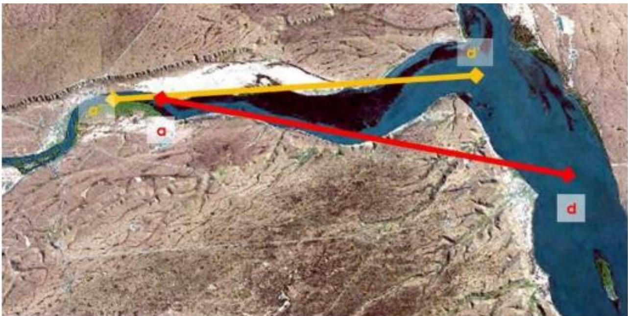
**Figura 1. Posiciones extremas de la IADS durante el mes de julio de 2016. En un escenario sin presa, la IADS se desplaza entre a y d (con caudal mínimo natural); las posiciones extremas de la IADS son a' y d' (con caudal mínimo extremo).**
